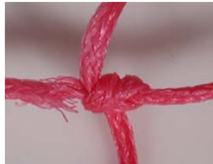
Rupture du polyéthylène après une exposition de 500 heures en appareil QUV, avant le test de résistance résiduelle à la traction.
