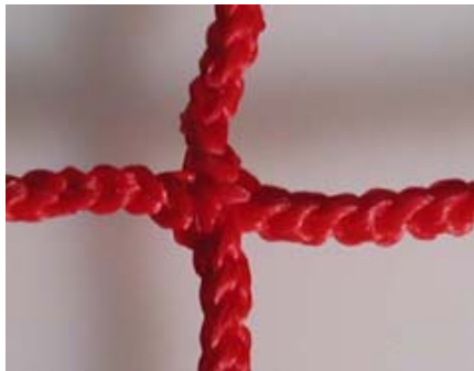
Le filet de nylon ne montre aucune évidence de détérioration après une période d'exposition de 500 heures en appareil QUV, avant le test de résistance résiduelle à la traction.
